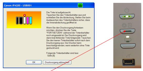
Drücken Sie die Taste "Fortsetzen" am Drucker siehe Bild vom Drucker anschliessend wird das Dokument normal fertig gedruckt. Fahren Sie weiter gemäss Punkt 5. **Achtung:** Bei den Multifunktionalen Geräten (z.B. Canon MP 500) ist dies die rote Taste mit dem auf dem Kopf stehenden Dreieck) ganz rechts auf dem Bedienfeld.
